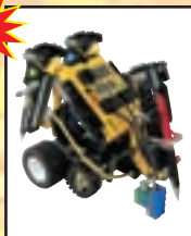
Система Robotics Invention System, программируемая с компьютера
